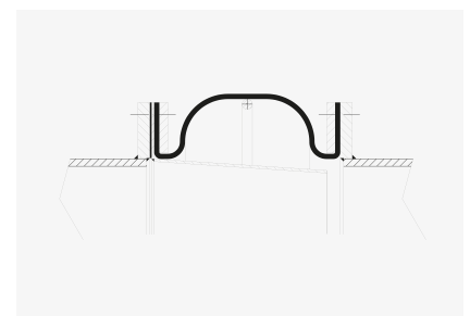
Einwellig mit Leitrohr, Vakuumstützring und Flanschen
