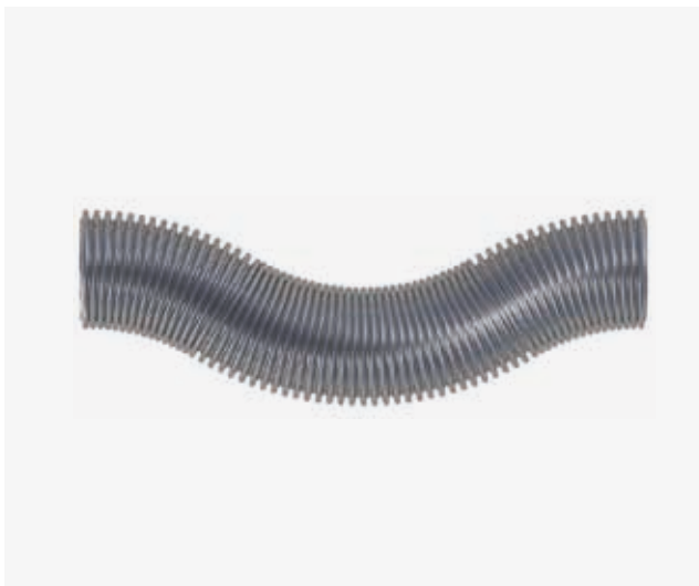
Knickinstabilität eines Stahlkompensators
